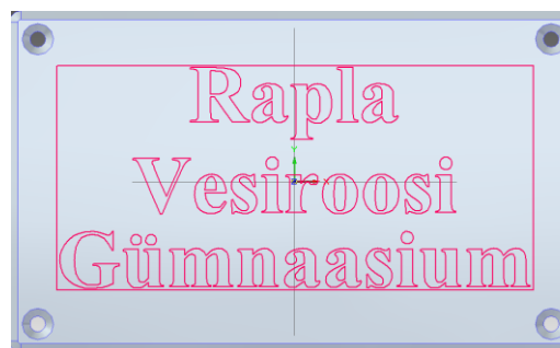
Joonis 11-185. Teksti eskiisi paigutamine plaadi pinnale
