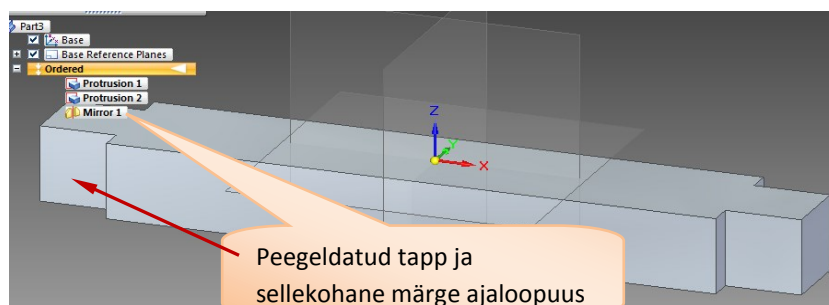
Joonis 11-29. Detaili modelleerimise keskkonna ISO Part ekraanipildi fragment. Peegeldusega on lisatud vasakpoolne tapp. Traaversi virtuaalne mudel on valmis
