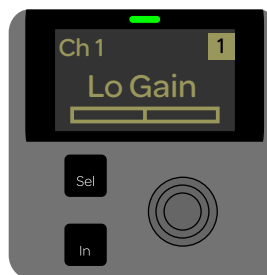
Channel Control showing the Lo Gain EQ parameter
