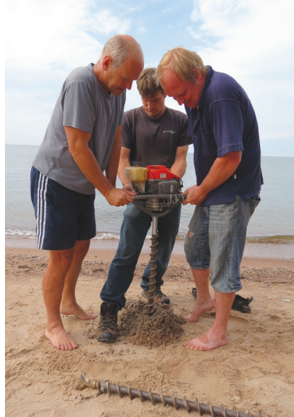
Joonis 3.4. Liivarandlal aktiivsele tormitegevusele alluva kobeda liivakihi paksuse määramisel ja proovide võtmisel on heaks abiliseks mootoriga kerge puurseade.
