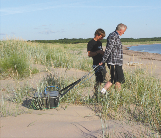
Joonis 3.5. Liikudes Harilaiu poolsaare kaelal eelluidete piires maaradriga Sir 3000 ja kasutades 100 MHz antenni, on võimalik eristada eri geneesiga setendeid kuni 15–20 m sügavuseni.
