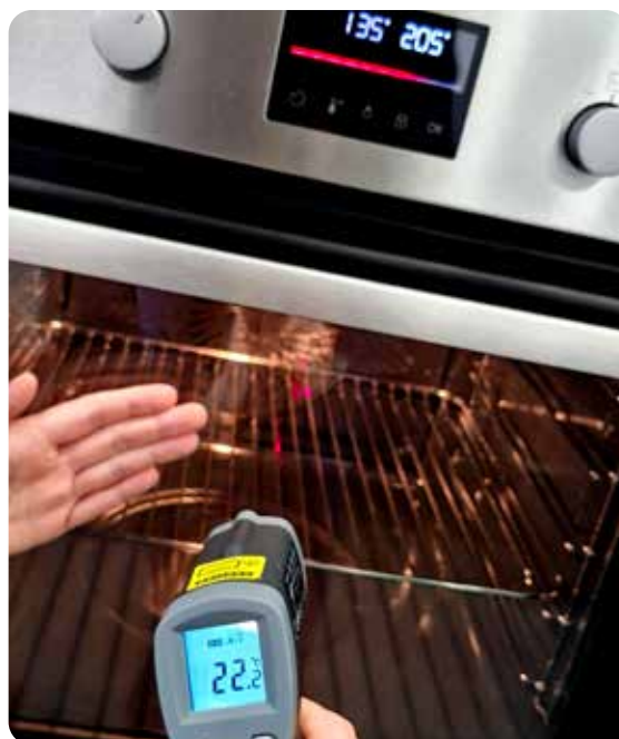
Joonised 33 ja 34. Erinevate temperatuuride mõõtmine infrapuna termomeetri abil.
