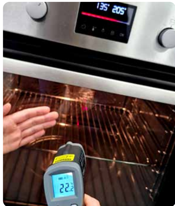
Kuvat 33 ja 34: Keittiön lämpötiloja voidaan mitata muun muassa infrapunamittarilla.
