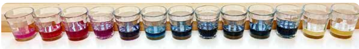
Kuvat 30 ja 31: Punakaalista valmistettu pH asteikko.
