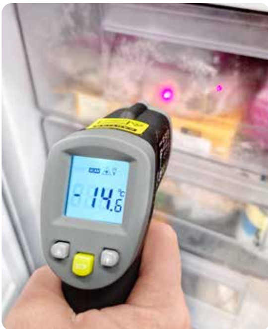
Kuvat 33 ja 34: Keittiön lämpötiloja voidaan mitata muun muassa infrapunamittarilla.
