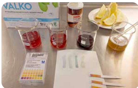
KALIBRIERUNG DER ROTKOHL-pH-SKALA UND DREI UNBEKANNTE REINIGUNGSMITTEL
