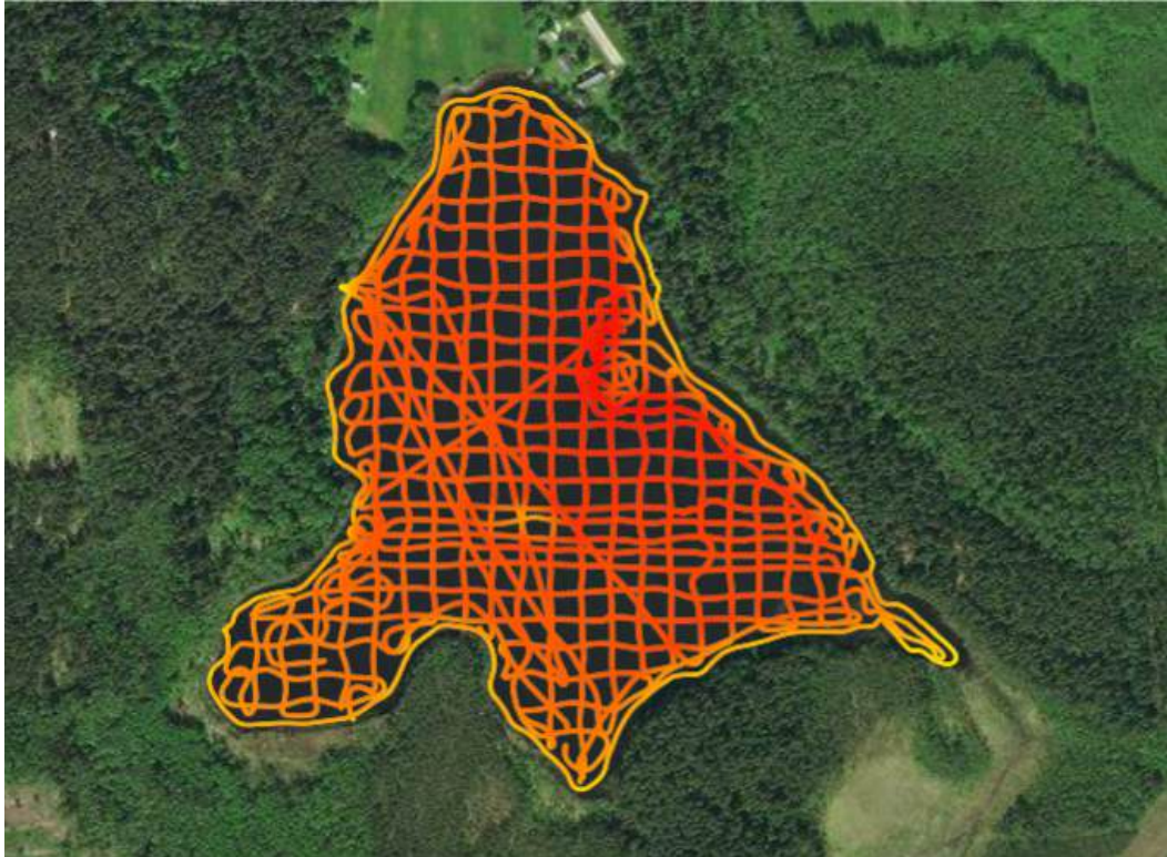
Joonis 3.11.1. Saare järve sügavusmöödistuste esialgsed töötlemata tulemused (värvi gradient madalast sügavasse: kollane-oranž-punane).
