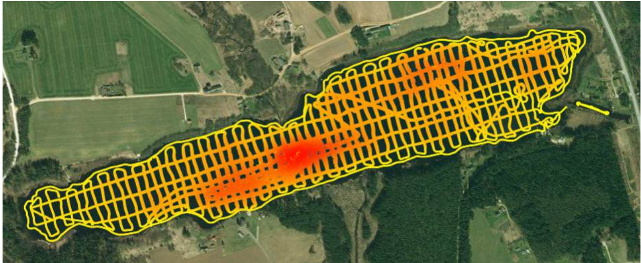
Joonis 3.2.1. Jõksi järve sügavusmõõdistuste esialgsed töötlemata tulemused (värvigradient madalast sügavasse: kollane-oranž-punane).
